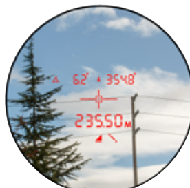
電柱監査 危険樹木や電線に接近する植生の測定 電柱の傾斜角、電柱間スパンの計測
