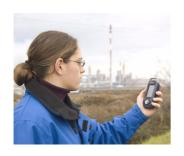
受信機は水平から 45° 傾けた状態で最も受信するように設計されています。また自分の体に近づけすぎないよう注意してください。
